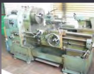
汎用旋盤 (切削物が回転する)
