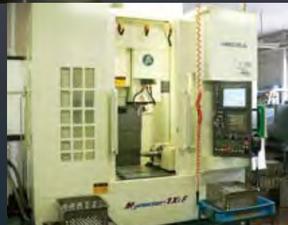
マシニングセンタ (NC フライスに工具交換装置が付いている)
